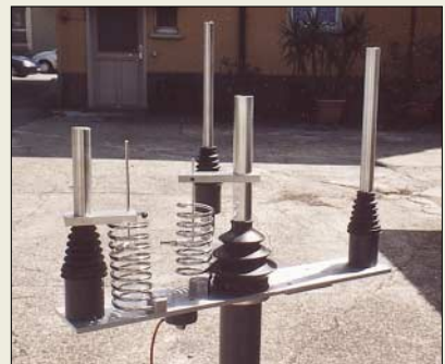
Fertig errichtete Antenne sowie unterer Rohrsteckaufbau mit Einspeisung und abgleichbereiten Fußpunktspulen
