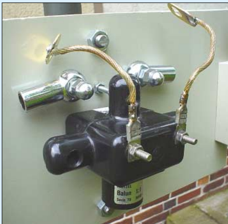
Bild 1: Vormontage des Mittelstückes mit DV-Adapter auf 3/8"-UNF-Gewinde, dem 1:1-Balun und den seitlichen Aufnahmehaltern
