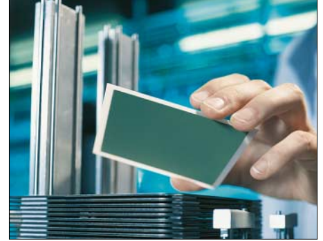
Das Herzstück der keramischen Hochtemperaturbrennstoffzelle: ein Stack genannter Komponentenstapel
