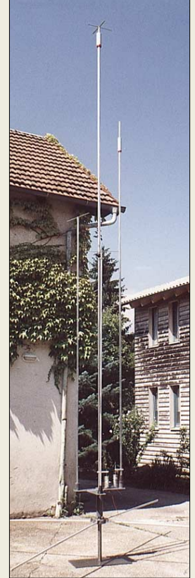
Fertig errichtete Antenne sowie unterer Rohrsteckaufbau mit Einspeisung und abgleichbereiten Fußpunktspulen
